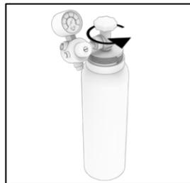
3) Bleibt der Gasdruck unter 2 bar, wenden Sie sich bitte an Ihren Gaslieferanten, um die Gasflasche zu wechseln.
