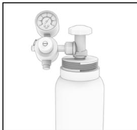
2) Wenn der Druck unter 2 bar liegt, prüfen Sie, ob die Gasflasche geöffnet ist. Erhöhen Sie den Gasdruck auf 4 bar, indem Sie die Schraube mit einem Schlitzschraubendreher drehen.
